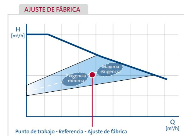
Si el punto de trabajo del sistema se va desviando del punto de referencia a lo largo del tiempo, la bomba reaccionará y ajustará su rendimiento automáticamente. En otras palabras, la bomba elegirá una curva de presión proporcional más alta en la que trabajar, si el sistema excede el punto de referencia y, al contrario; se moverá a una curva inferior, si el punto de referencia excede la demanda del sistema.
